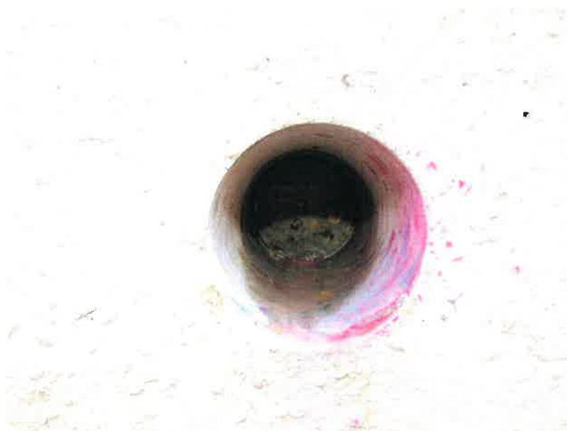
Pohled do otvoru po odběru vzorku betonu číslo 4
