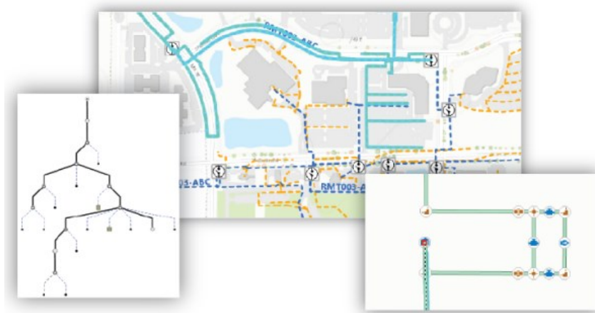
Obr. 42 Detailní modelování prvků utilitní sítě a její schematické zobrazení
